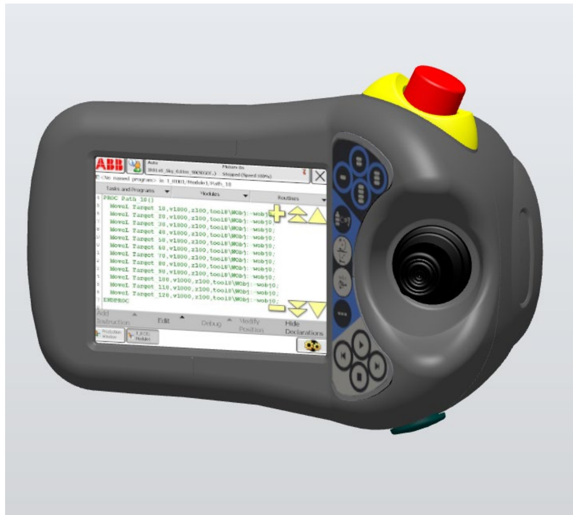
Käsiohjain (FlexPendant) – Kannettava ohjauslaite ohjelmointiin ja liikkeiden opettamiseen
