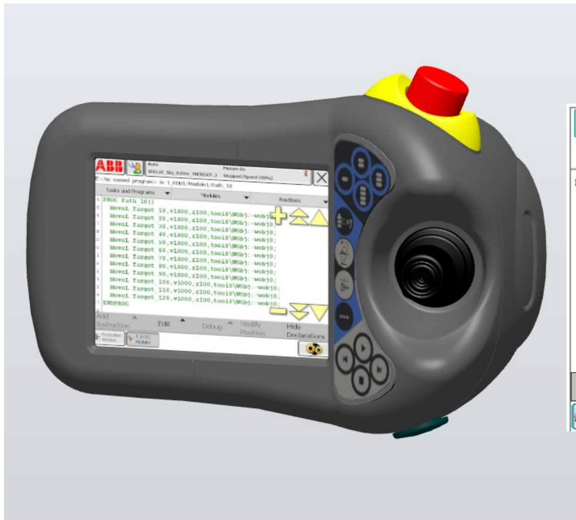
Käyttöliittymä (User interface) – Näyttö ja painikkeet, joilla ohjataan
